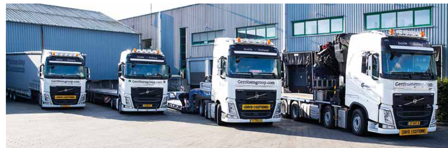
Bijzonder is de geheel elektrische kraan, met een hefcapaciteit van 58 ton
